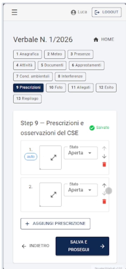
Fig. 37 — Passo 9: la prescrizione n. 1 è automatica (chip auto ), la n. 2 è stata aggiunta a mano; per entrambe stato, riordino ed eliminazione.
